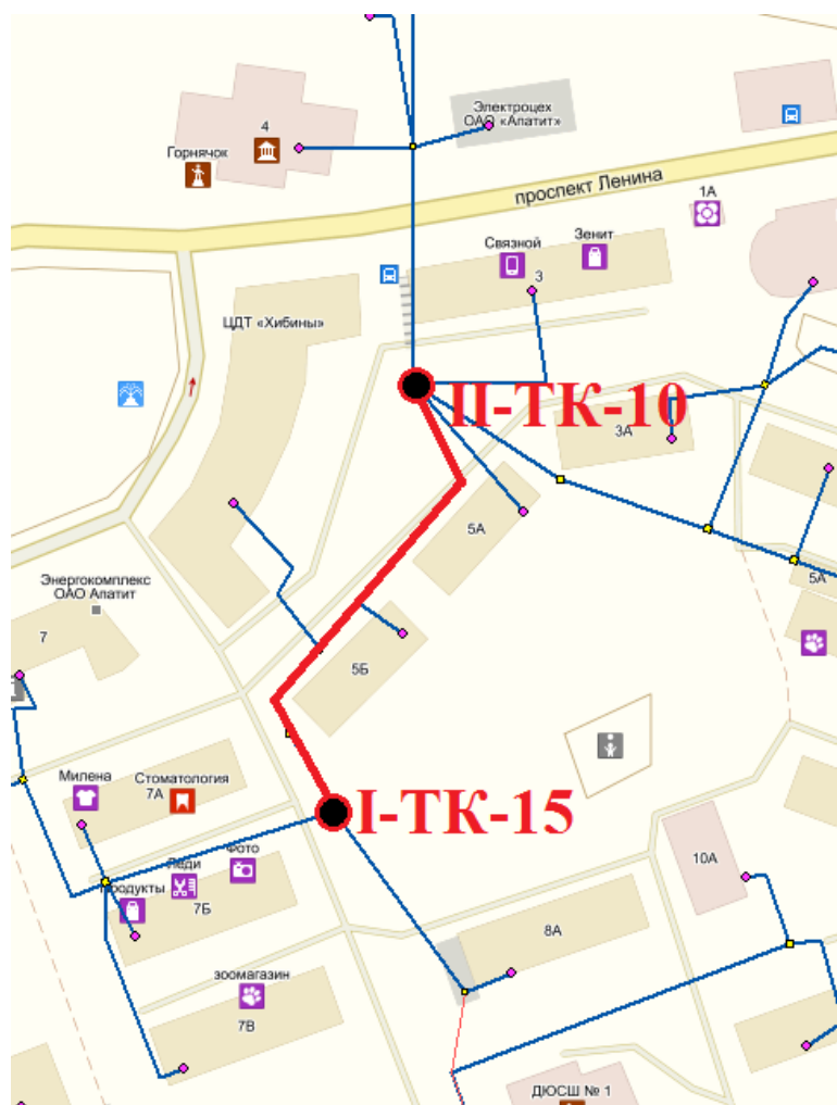
Рисунок 5.4 Схема предлагаемого к реконструкции участка тепловой сети
