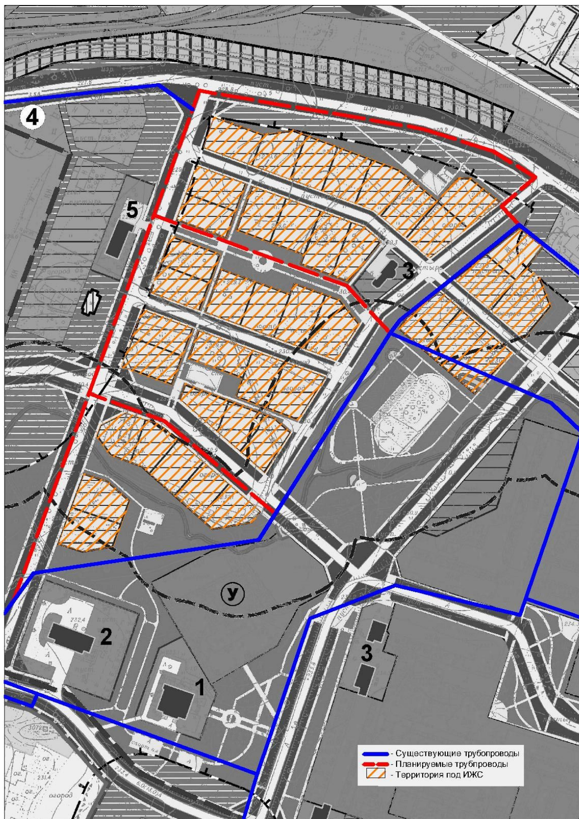
Рисунок 2. Трубопроводы, н.п. Титан
