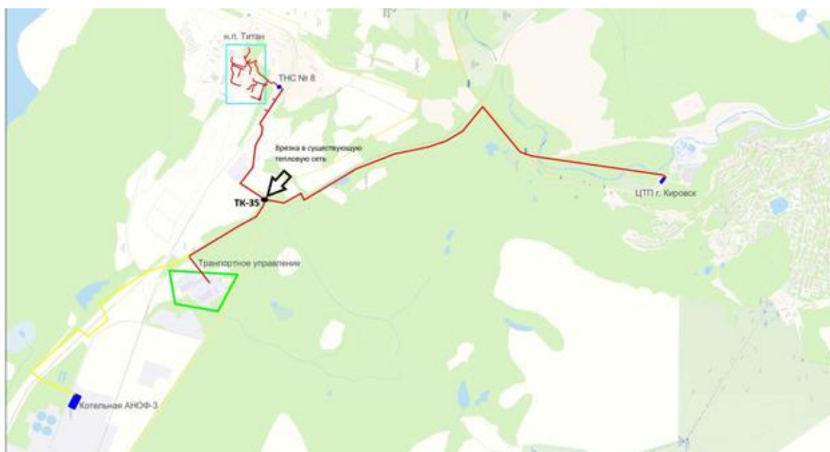
Рисунок 5 - Предлагаемая схема прокладки тепломагистральной до н.п. Титан
