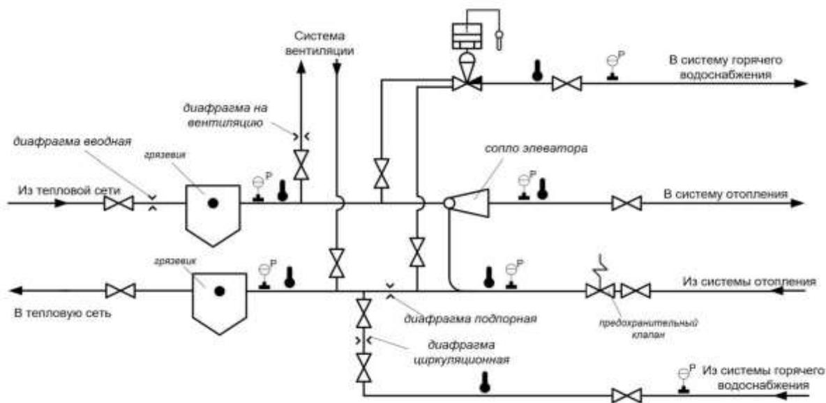
Рисунок 1.3.16.2 - Принципиальная схема наиболее распространенного присоединения
