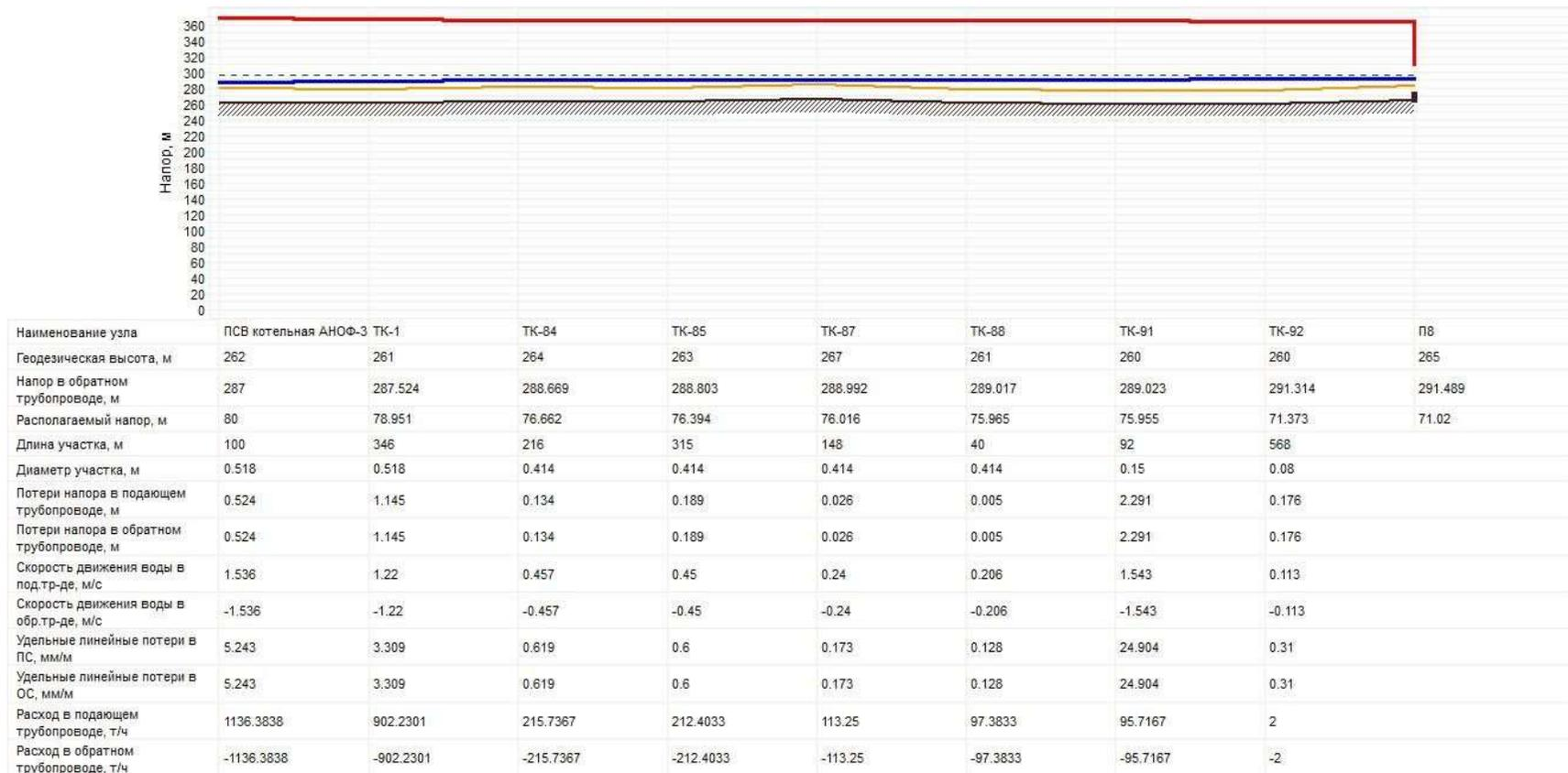
Рисунок 1.6.3.8 - Пьезометрический график от котельной АНОФ-3 до промзоны
