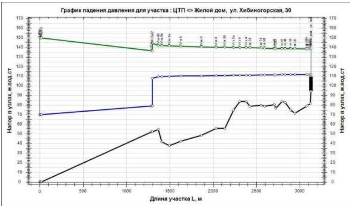
Рисунок 1.3.8.7 - Пьезометрический график потерь напора в трубопроводах от ЦТП г. Кировск до потребителя тепловой энергии
