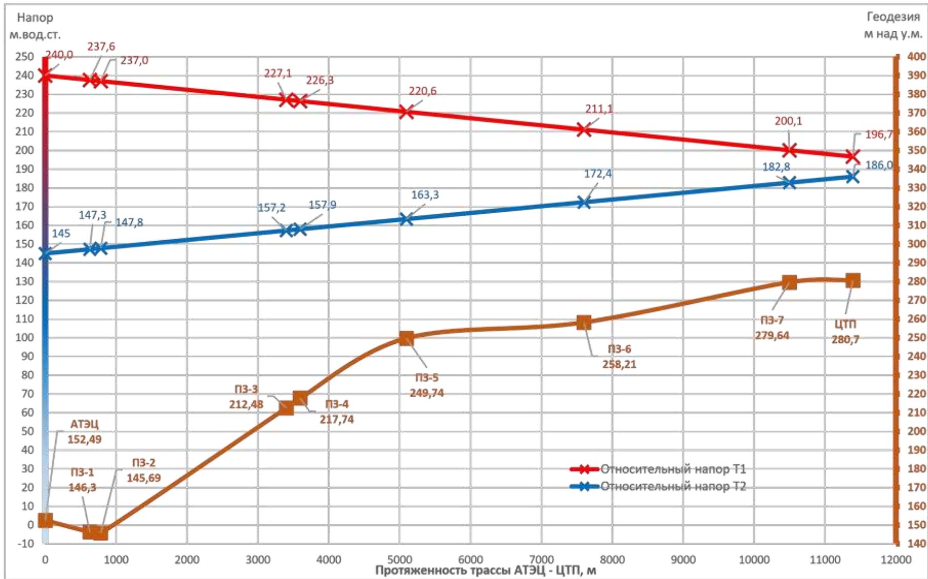
Рисунок 1.3.8.1 - Пьезометрический график переходного режима работы тепломагистрали.
