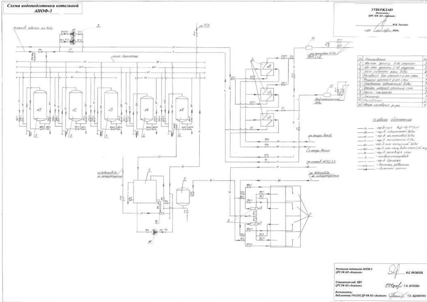
Рисунок 1.7.1.1 - Схема водоподготовки АНОФ-3
