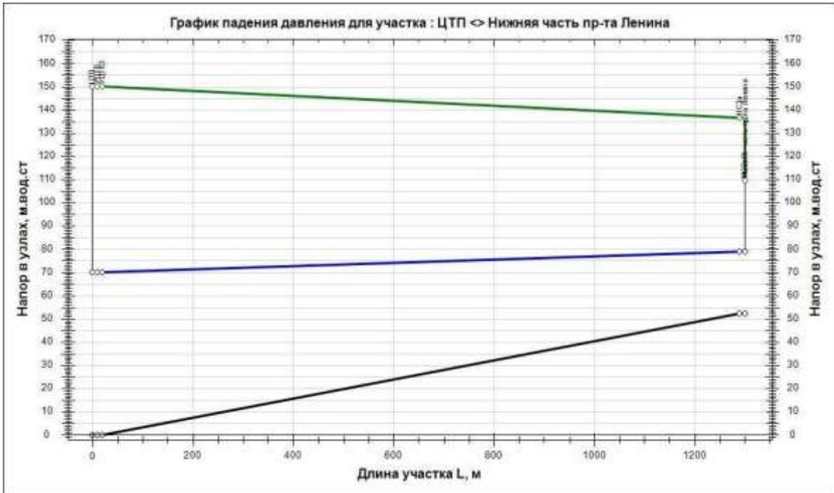
Рисунок 1.3.8.6 - Пьезометрический график потерь напора в трубопроводах от ЦТП г. Кировск до потребителя тепловой энергии
