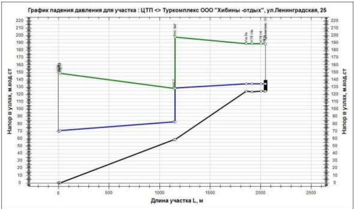
Рисунок 1.3.8.4 - Пьезометрический график потерь напора в трубопроводах от ЦТП г. Кировск до потребителя тепловой энергии
