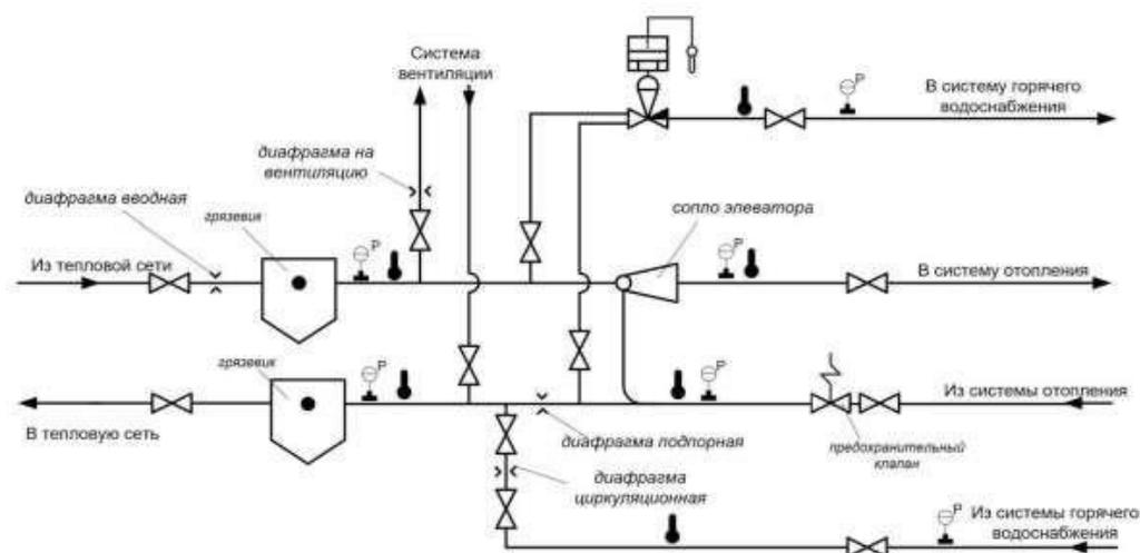
**Рисунок 25 - Принципиальная схема наиболее распространенного присоединения**
