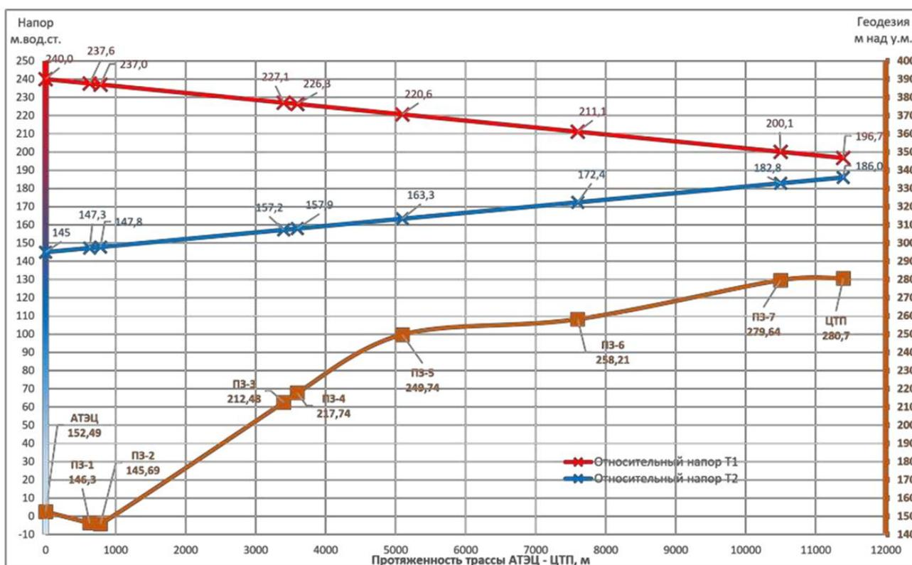
**Рисунок 17 - Пьезометрический график переходного режима работы тепломагистрали**
