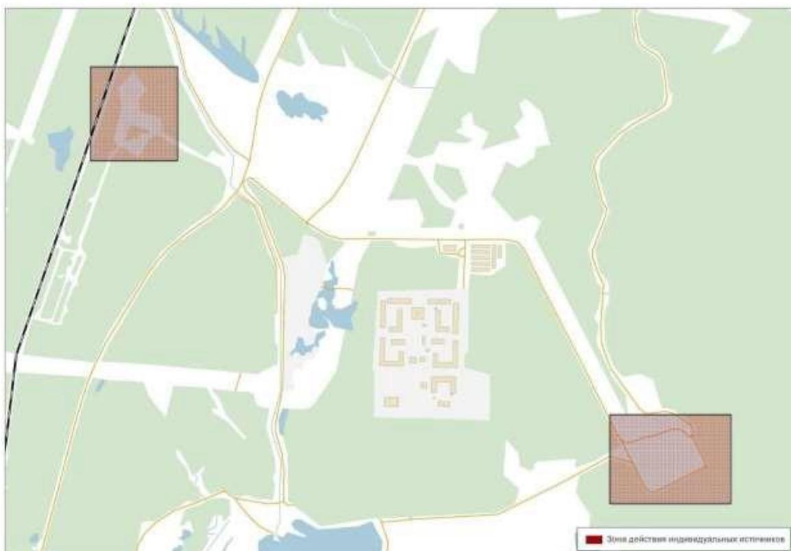
Рисунок 5 - Зоны действия индивидуальных источников теплоснабжения
