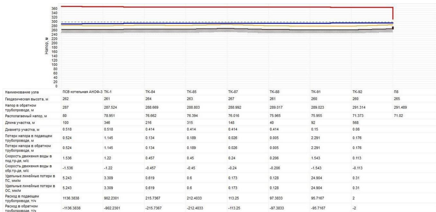
Рисунок 10 - Пьезометрический график от котельной АНОФ-3 до промзоны
