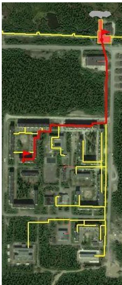
Рисунок 40 - Направление №2 от электрической БМК н.п. Коашва
