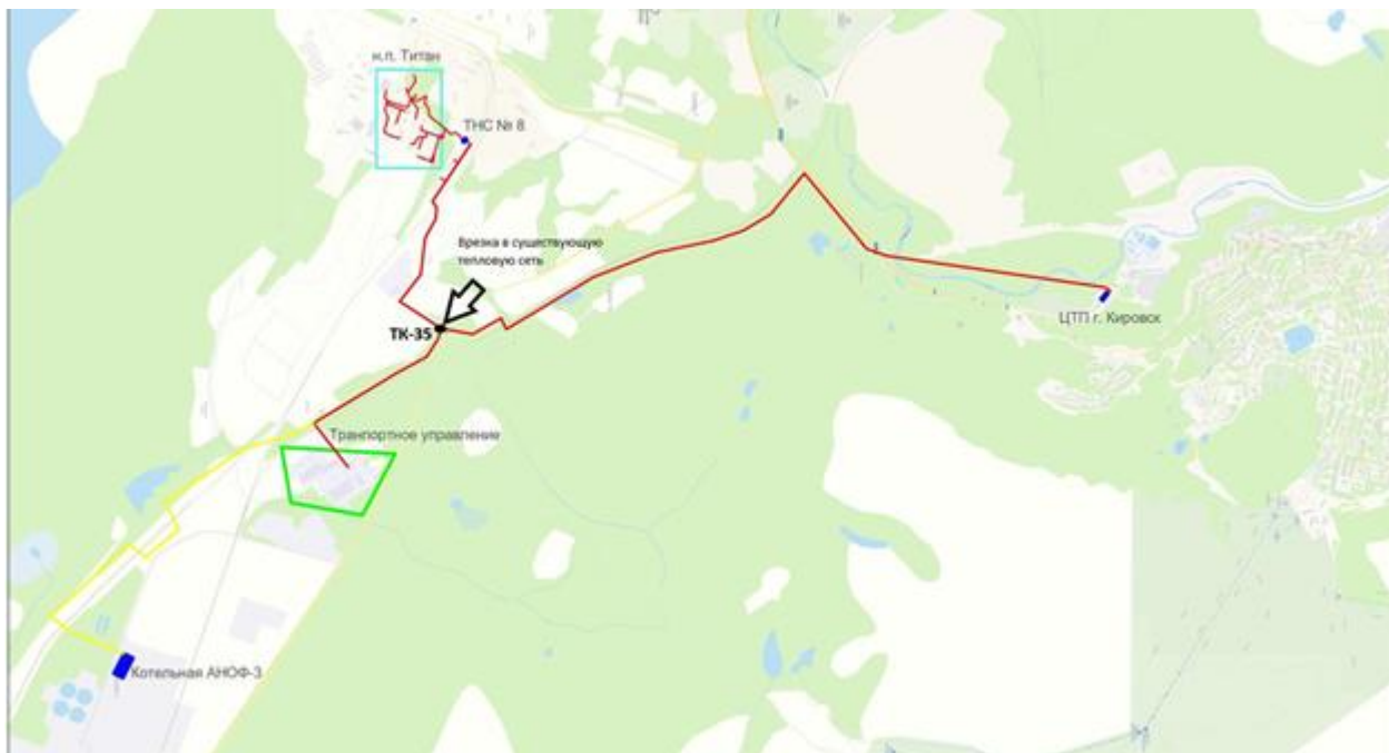
Рисунок 19 - Предлагаемая схема прокладки тепломагистрали до н.п. Титан
