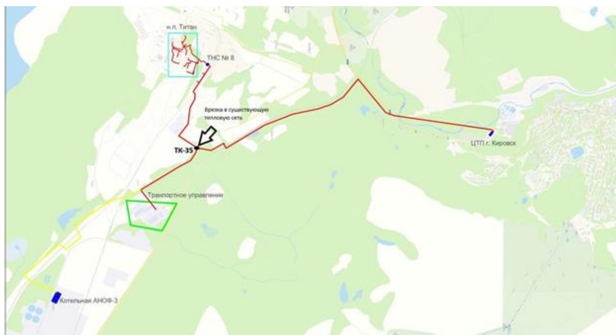
Рисунок 14 - Предлагаемая схема прокладки тепломагистрали до н.п. Титан
