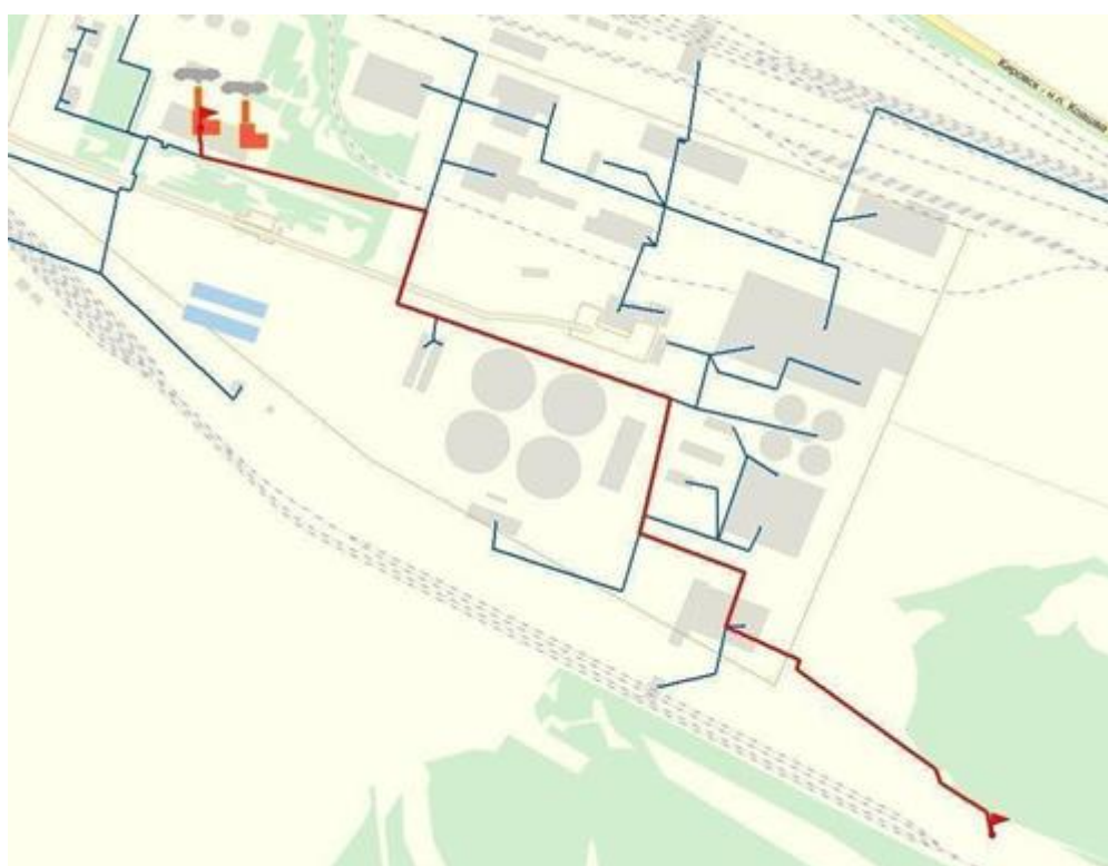
Рисунок 35 - Направление №1 от котельной АНОФ-3
