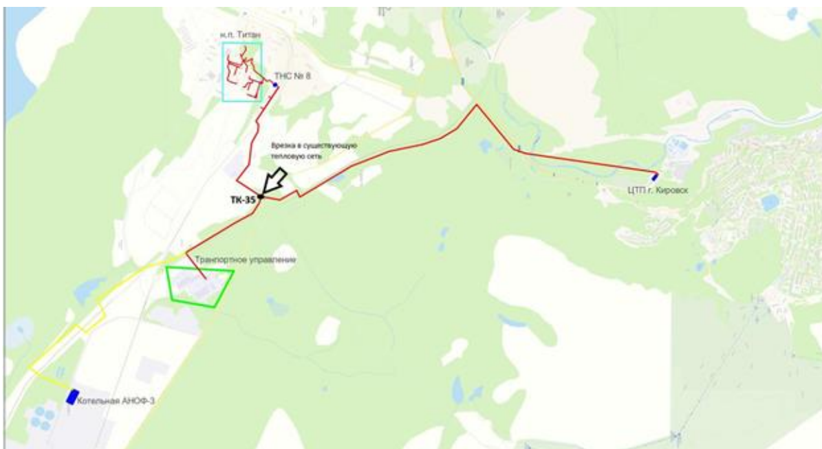
Рисунок 5 - Предлагаемая схема прокладки тепломагистрали до н.п. Титан
