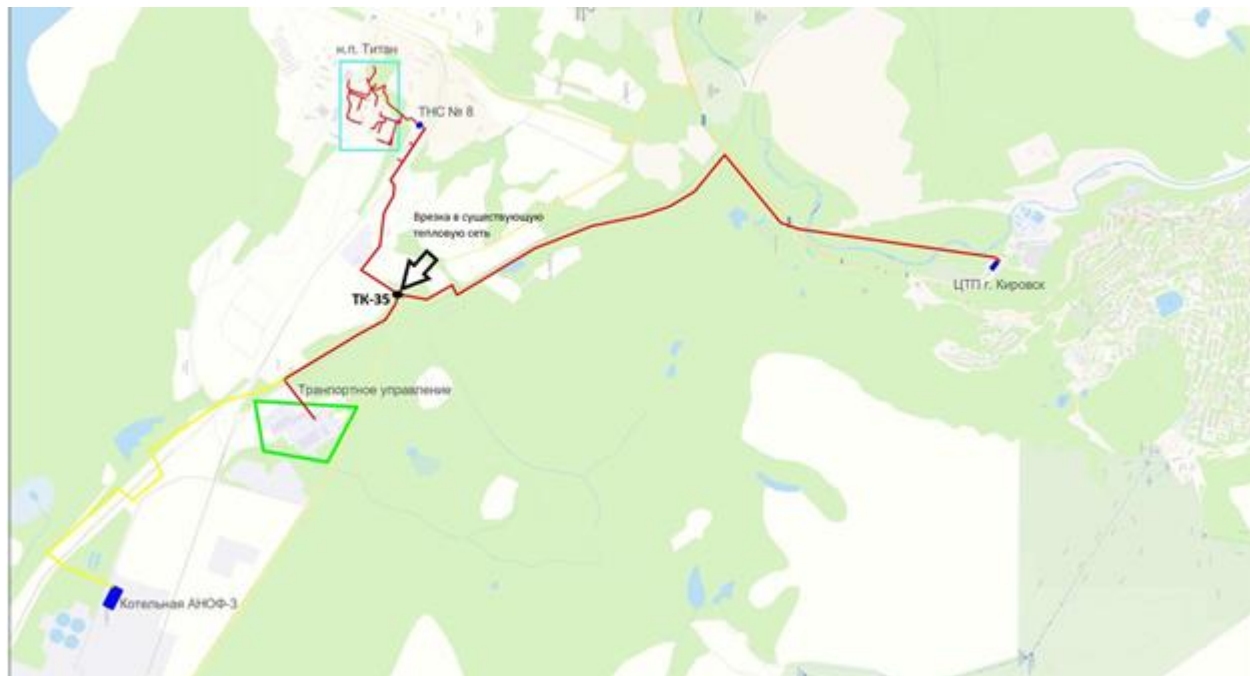
Рисунок 15 - Предлагаемая схема прокладки тепломагистрали до н.п. Титан
