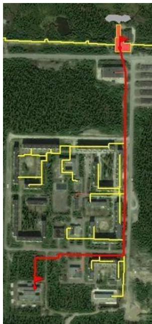
Рисунок 27 - Направление №1 от электрической БМК н.п. Кошва
